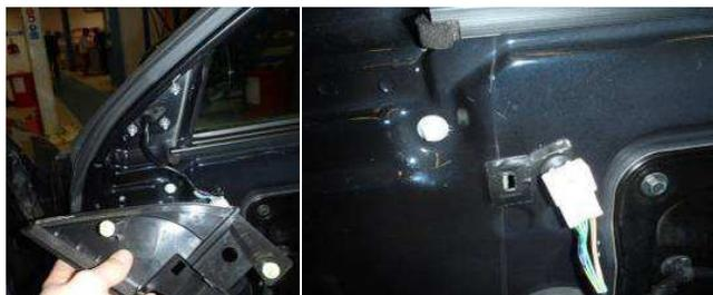
14. Отверните 3 болта, фиксирующих наружное зеркало, и аккуратно отсоедините зеркало в сборе от двери.
