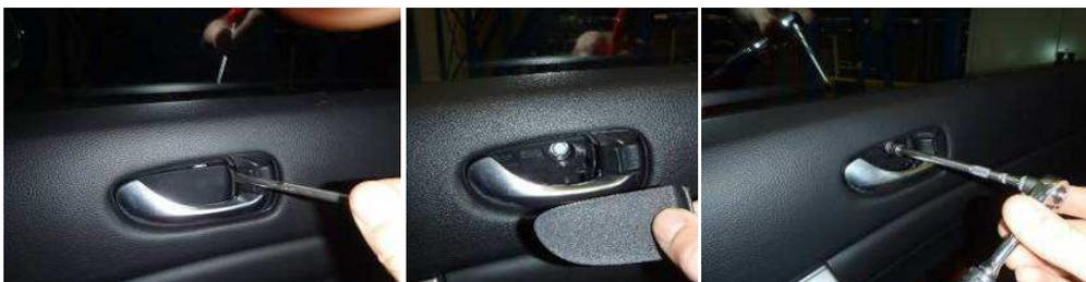
5. Аккуратно снимите крышку на панели двери и отверните фиксирующий винт.
