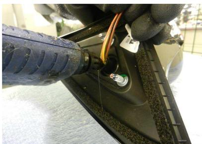
**ПРИМЕЧАНИЕ:** на автомобилях, выпущенных после 09/03/2012 (т.е. в период В), применяется временная контрмера - в точке захода жгута проводов в уплотнитель наружного зеркала наносится термоклей. Однако, в некоторых случаях эта операция была проведена некорректно, в результате чего внутрь проникает вода.
