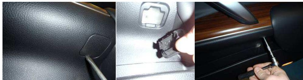
6. Аккуратно снимите накладку внутренней ручки двери и отверните фиксирующий винт.
