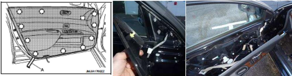
22. Снимите с внутренней части двери крышку наружного зеркала, для того чтобы получить доступ к его элементам крепления.
