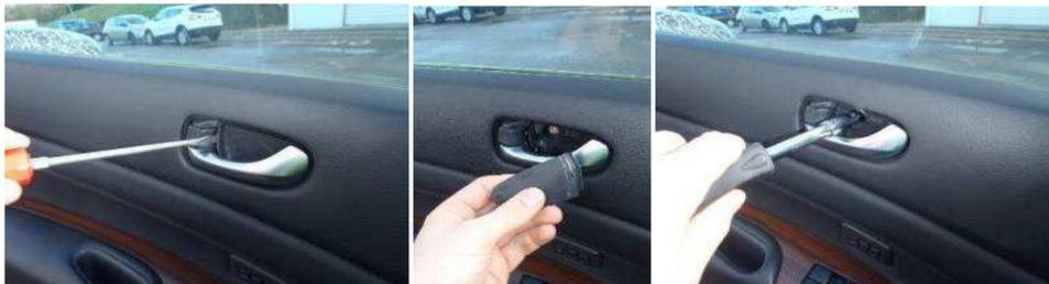
16. Аккуратно снимите крышку на отделке двери и отверните фиксирующий винт.
