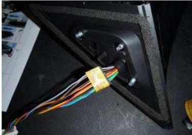
36. Придайте бутиловой полосе с проводами цилиндрическую форму и убедитесь, что диаметр получившегося цилиндра превышает диаметр отверстия в уплотнителе (добавьте больше бутиловой ленты, если это потребуется).
