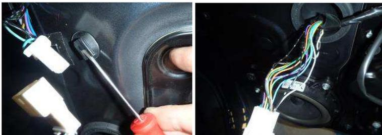
59. Нанесите временные метки на расстояниях 40, 70 и 100 мм от разъема.
