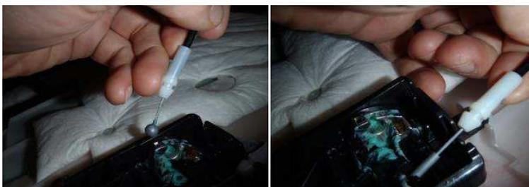
10. Отсоедините электропроводку подсветки внутренней ручки двери, переключателя электростеклоподъемника и лампы местной подсветки.
