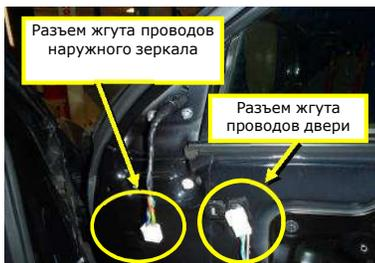
26. Если нет видимых следов коррозии или повреждений от перегрева под воздействием электрического тока (т.н. оплавленный разъем), то разъем находится в удовлетворительном (ОК) состоянии.
