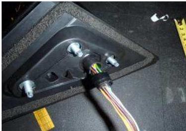
37. Задвиньте получившийся пучок из бутиловой ленты в отверстие на уплотнителе так, чтобы обеспечить его водонепроницаемость.
