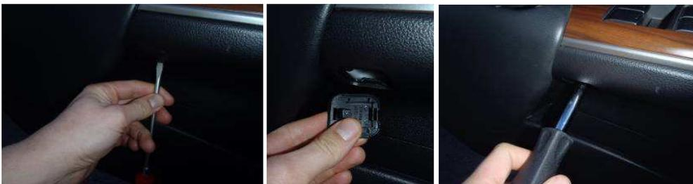
17. Аккуратно отсоедините по периметру декоративную панель двери (расположение фиксаторов декоративной панели показано на рисунке ниже).
