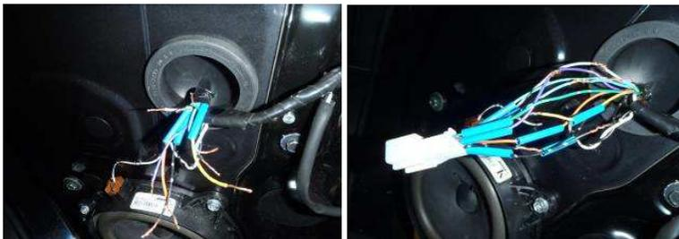
68. Включите электрический паяльник. Используя припой, спаяйте по одному все 9 проводов.
