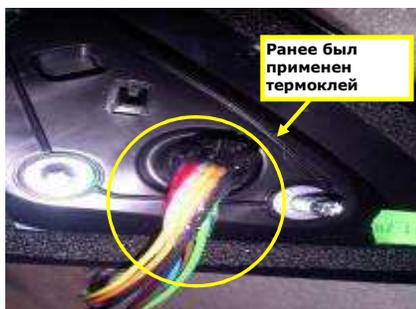
**Если на разъемах жгута проводов нет видимых следов коррозии, то никаких дополнительных действий не требуется (т.е. нет необходимости применять бутиловую ленту для дополнительной герметизации). Аналогичная ситуация для автомобилей, на которых в сервисном центре производилась замена наружного зеркала, при которой в качестве временной контрмеры был нанесен термоклей.**
