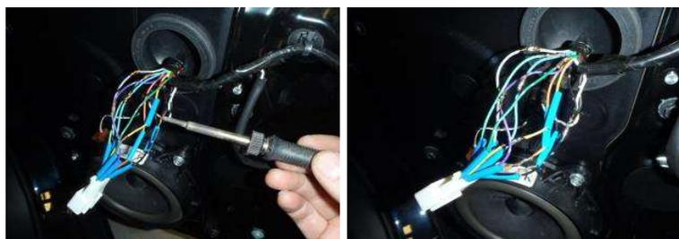
70. Сдвиньте термоусадочные трубки так, чтобы на каждом проводе точка спайки находилась в середине трубки.
