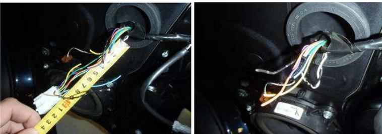
64. В соответствии с длинами проводов на поврежденном разъеме (40, 70 и 100 мм) обрежьте провода на новом разъеме жгута проводов (70, 100 и 130 мм). Для упрощения этого шага можно положить поврежденный разъем (длина которого составляет около 30 мм) на точку выхода проводов из нового разъема и обрезать соответствующие провода на одинаковую длину.
