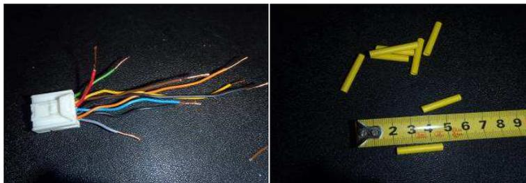
50. Наденьте термоусадочные трубки на каждый провод и скрутите оголенные концы проводов, подходящих по цвету и длине.
